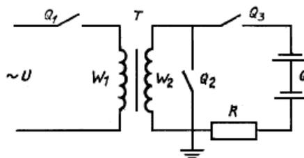
$Q_1, Q_2, Q_3$  - выключатели;  $T$  - испытуемый трансформатор;  $G$  - источник постоянного тока;
